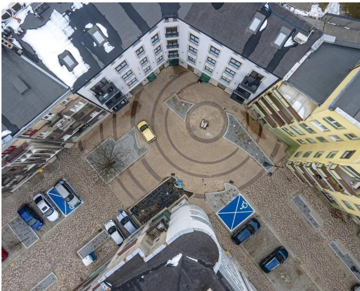
Rysunek 5.4 Woonerf w Łodzi (ul. Lipowa) – wydzielono przestrzeń tylko do parkowania samochodów, pozostała przeznaczona jest dla wszystkich uczestników ruchu, co podkreśla jednolita nawierzchnia
